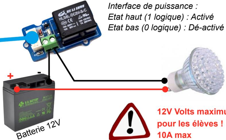
Exemple ici avec une interface de puissance (relais) sur le port D7 qui permet de piloter une lampe qui clignote toutes les 10 secondes
